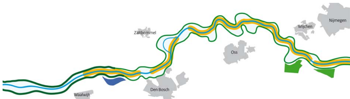
Figuur 13: Hoofdkeuze + grote ingrepen In oranje de uiterwaardverlagingen en een nevengeul. In groen de dijkophoging van 30 cm (excl. de kwetsbare trajecten). Rechts in de figuur de 2 retentiegebieden. Links in de figuur zomerbedverbreding, aanvullende dijkverhoging en dijkverlegging bij Bokhoven.
