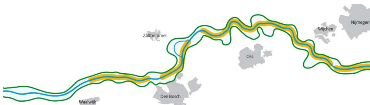
Figuur 3 laat de hoofdkeuze voor de gehele bedijkte Maas zien. In oranje de uiterwaardverlagingen en een nevengeul. In groen de dijkophoging van 30 cm (excl. de kwetsbare trajecten)
