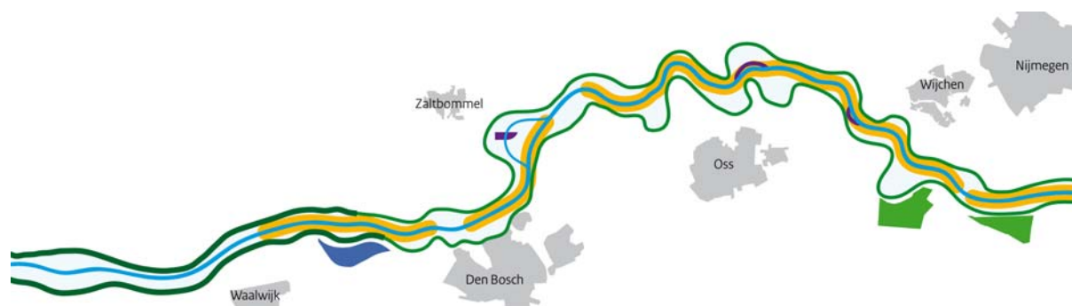
Figuur: Schematische weergave van de potentiële voorkeurstrategie In oranje de uiterwaardverlagingen en een nevengeul. In groen de dijkophoging van 30 cm (excl. de kwetsbare trajecten). Rechts in de figuur de 2 retentiegebieden. Links in de figuur zomerbedverbreding, aanvullende dijkverhoging en dijkverlegging bij Bokhoven. In paars de drie locaties voor aanvullende keuzen.
