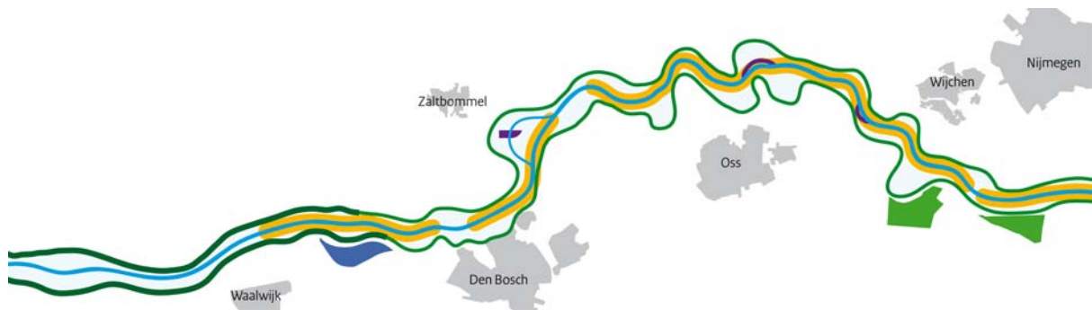
Figuur 14: Hoofdkeuze + grote ingrepen + aanvullende keuzen In oranje de uiterwaardverlagingen en een nevengeul. In groen de dijkophoging van 30 cm (excl. de kwetsbare trajecten). Rechts in de figuur de 2 retentiegebieden. Links in de figuur zomerbedverbreding, aanvullende dijkverhoging en dijkverlegging bij Bokhoven. In paars de drie locaties van de aanvullende keuzen.
