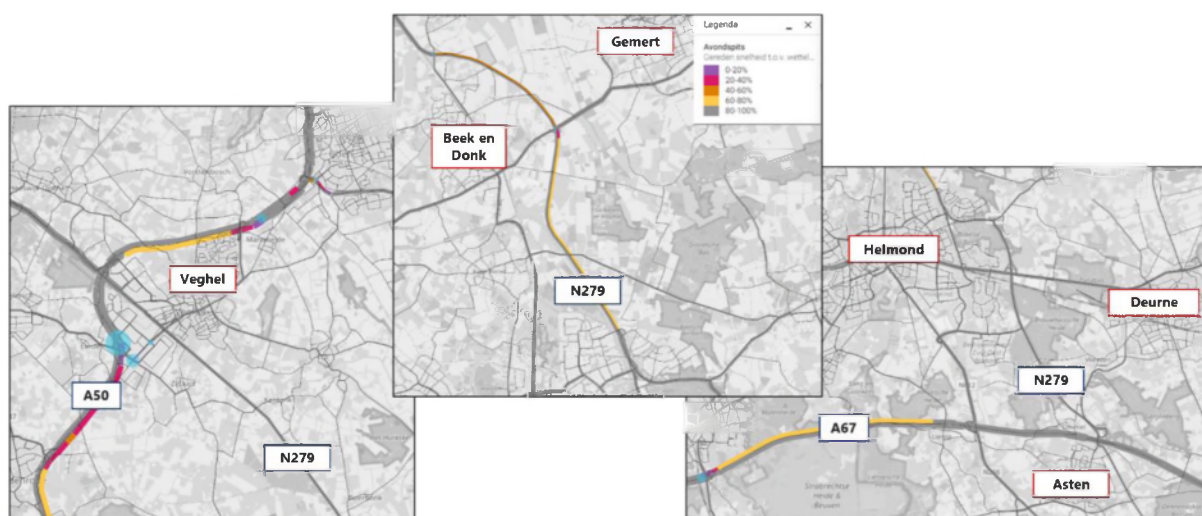
Figuur 6.12: Filekiemen en gereden snelheid in de variant 2040 met vrachtwagenheffing en verstedelijkingsopgave tijdens de avondspits.
