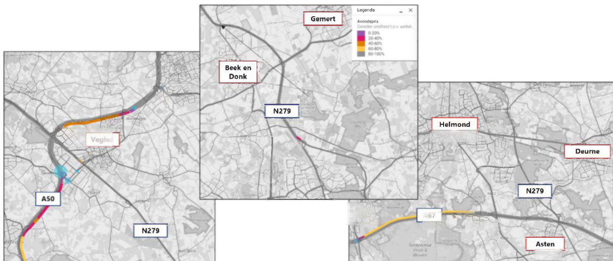
Figuur 6.4: Filekiemen en gereden snelheid in de variant 2040 met PIP N279 tijdens de avondspits.
