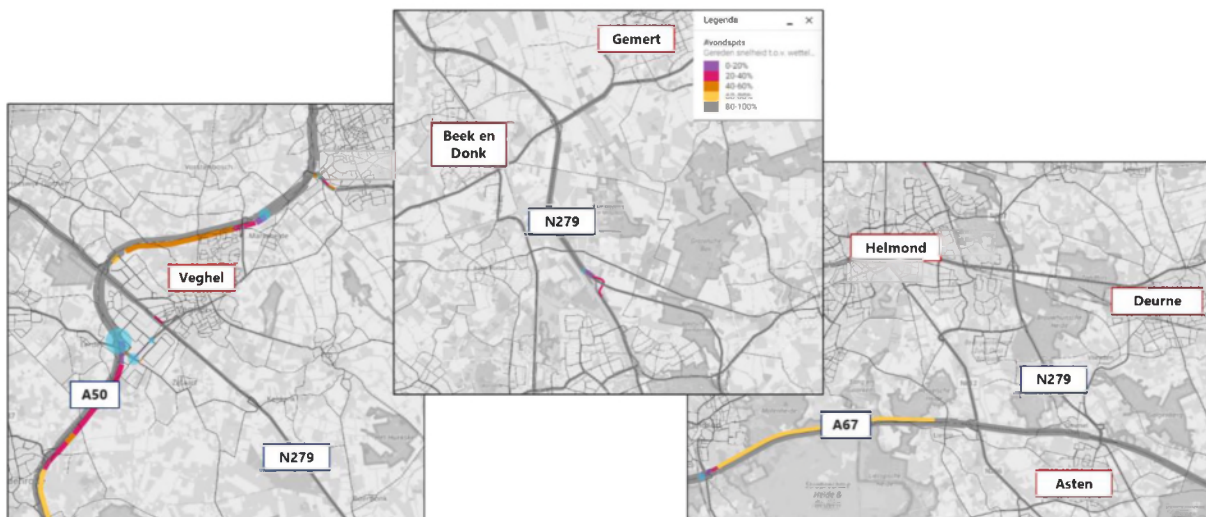
Figuur 6.8: Filekiemen en gereden snelheid in de variant 2040 met PIP N279 + VH tijdens de avondspits.
